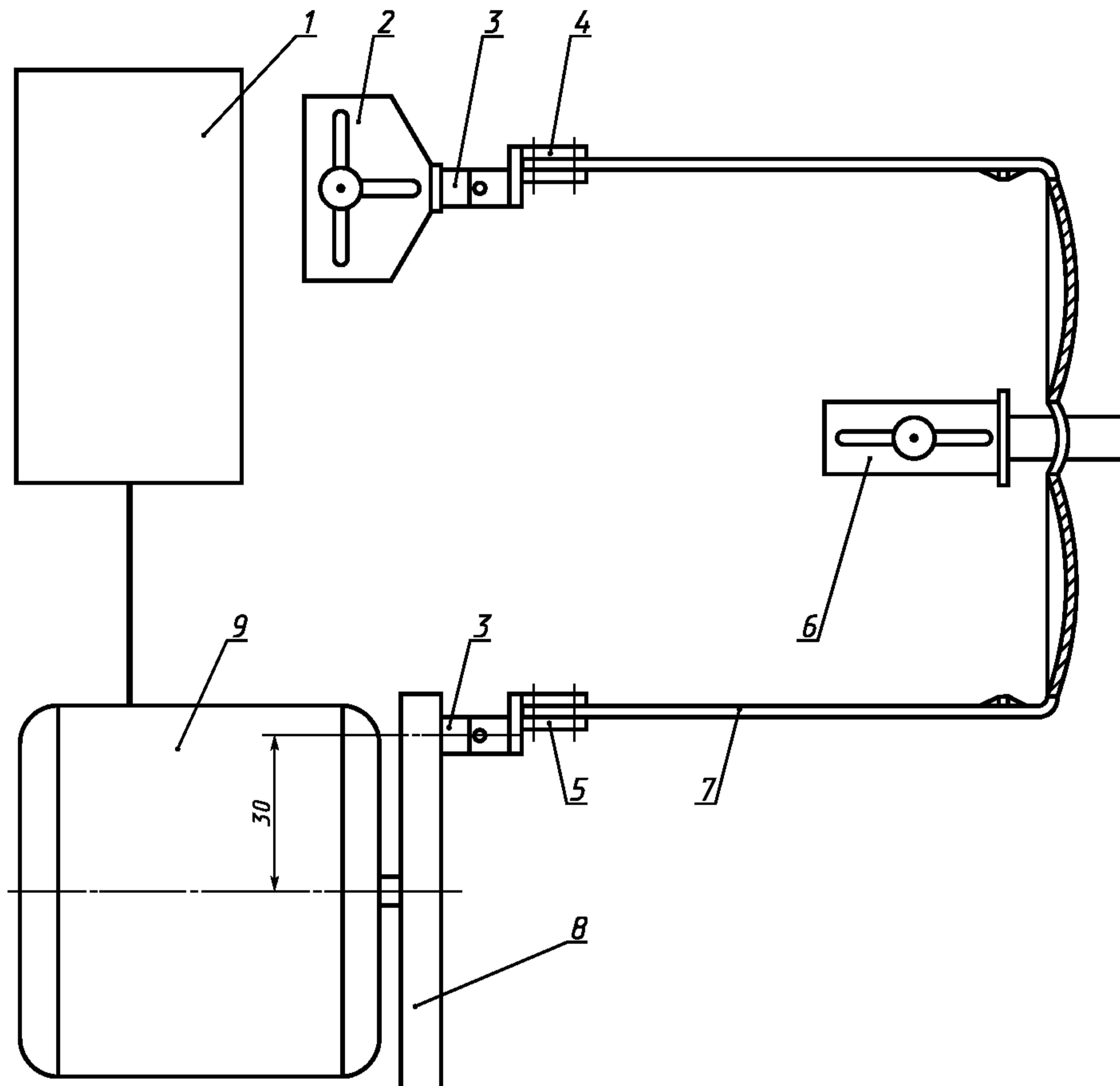
1 — контрольная панель и счетчик; 2 — регулятор зажима заушника; 3 — универсальный шарнир; 4 — фиксированный зажим R; 5 — подвижный зажим M; 6 — узел поддержки моста; 7 — испытуемый образец; 8 — врачающийся диск; 9 — приводной мотор
